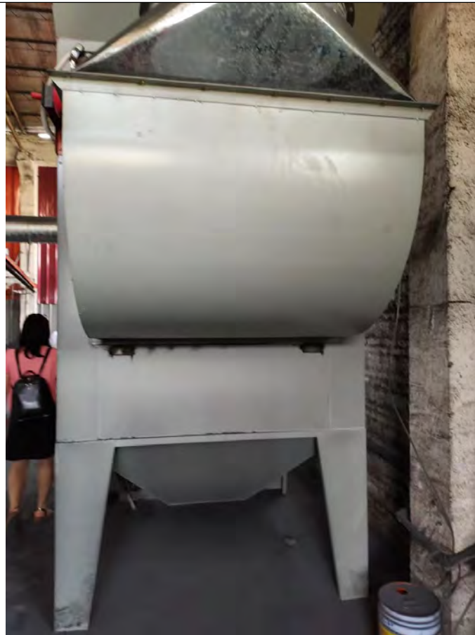
喷粉下沉装置
